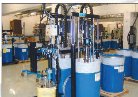
Bombas de extrusión, de relación 23:1, usadas en un montaje de múltiples componentes para la transferencia de silicona.
