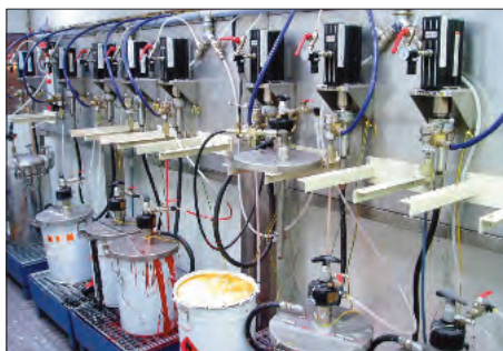
Bombas de pistón de 2 bolas, de relación 4:1, usadas en un proceso de fabricación de pintura.
