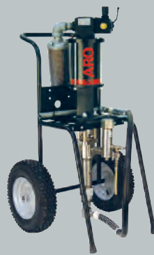
Conjuntos para pulverización "Airless" Muy populares en las aplicaciones "Airless", estos conjuntos se entregan con control de aire, filtro de material y manguera de aspiración.
