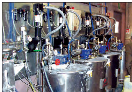
Bombas de pistón de 2 bolas, de relación 11:1, usadas en un proceso de recirculación de pintura.
