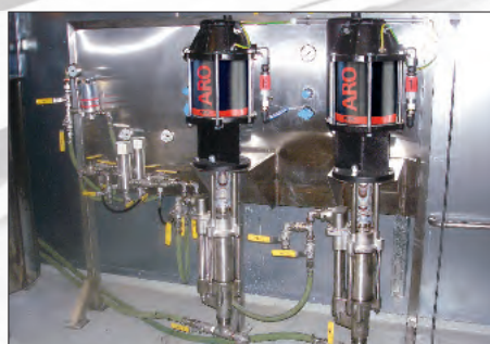
Bombas de extrusión, de relación 23:1, usadas en un montaje de múltiples componentes para la transferencia de silicona.
