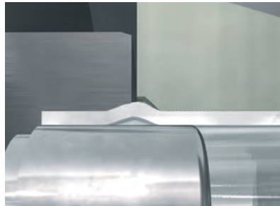
La forma de la herramienta define el contorno externo de la pared del tubo formada
